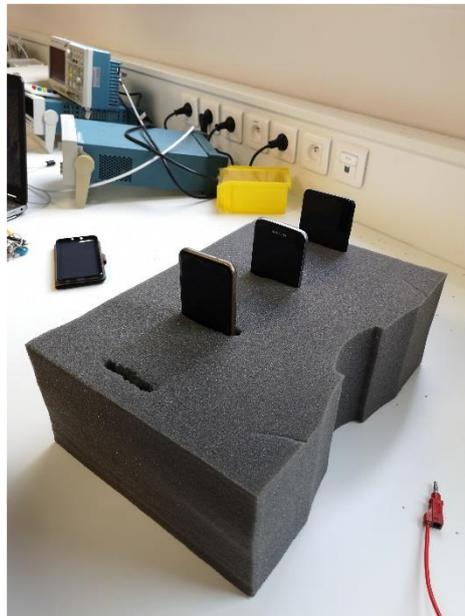
Figure 3 - Photo du bloc de mousse avec les 4 emplacements pour les smartphones
